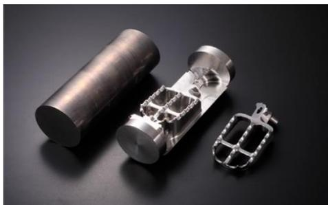
マシニングでパートを分け加工することで、2軸加工機での製作を実現。
